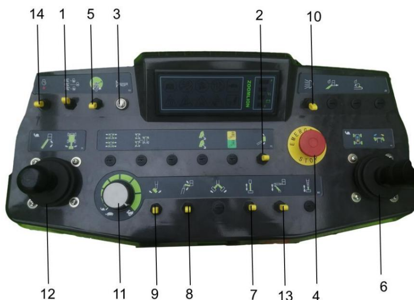
Figura 2-6 Panoul de control al platformei (este identificat doar numărul comutatorului corespunzător funcției existente.)
